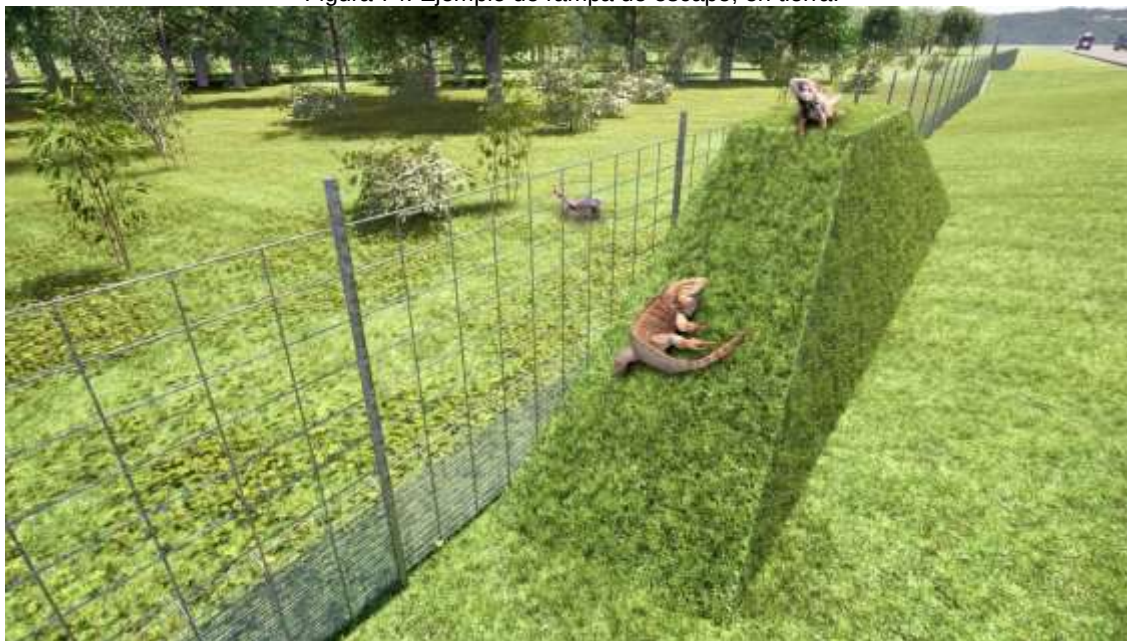
Figura 74: Ejemplo de rampa de escape, en tierra.
